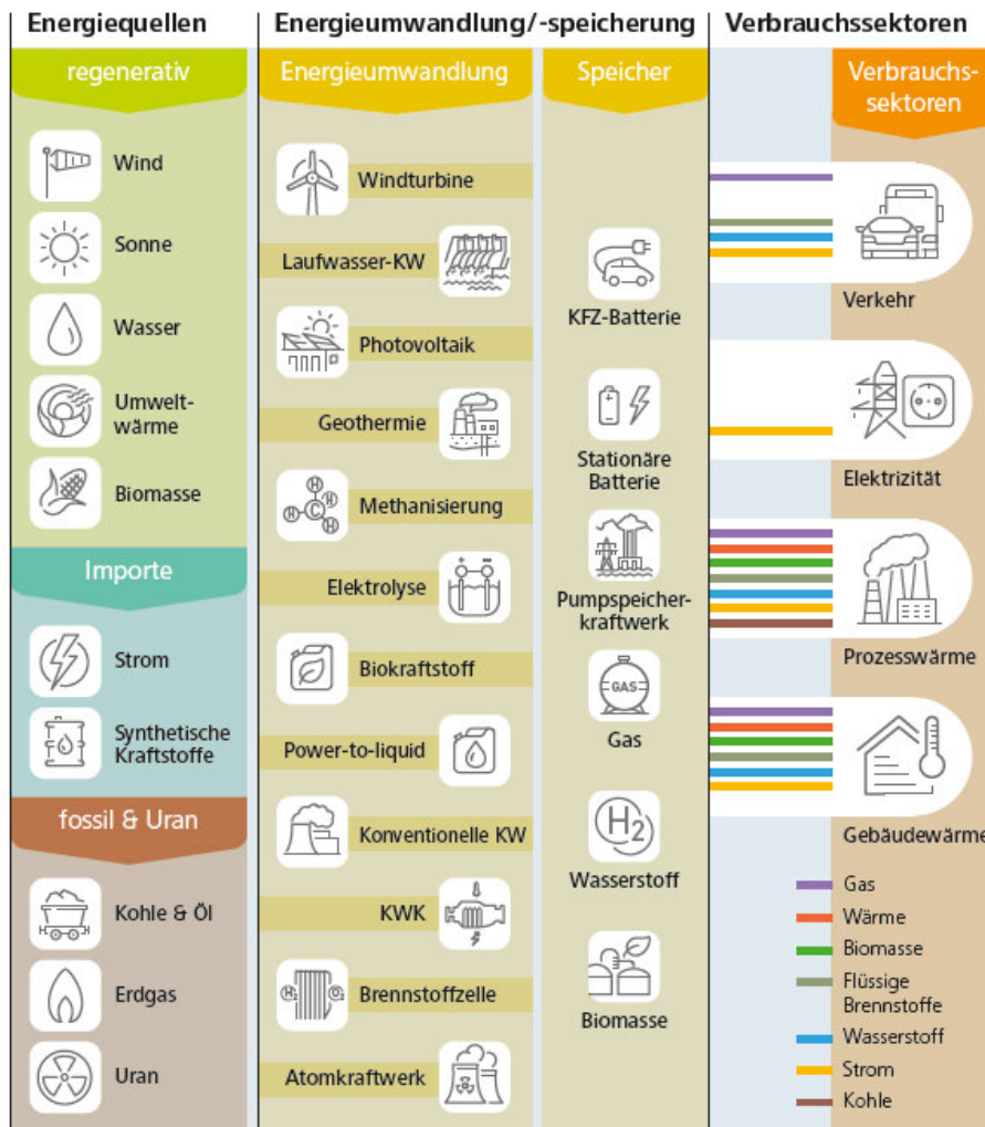
Abbildung 49: Schematische Darstellung des Modells REMod (KW: Kraftwerk, KWK: Kraft-Wärme-Kopplung, [ISE12])
